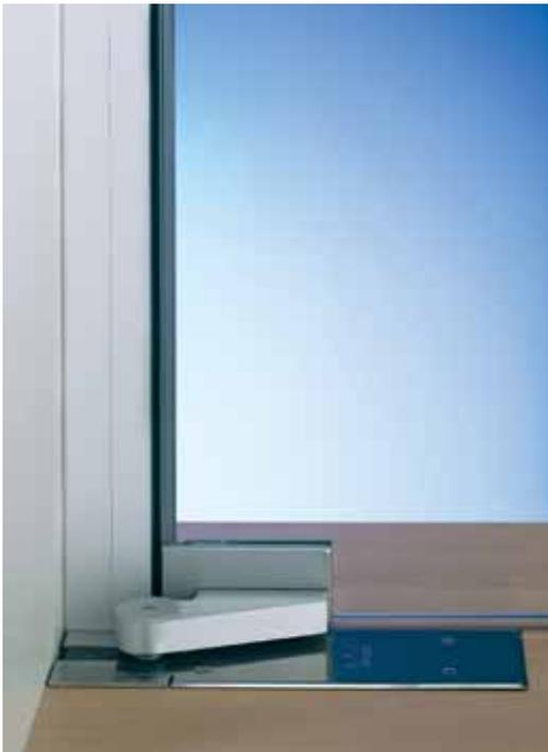
Für Türanlagen mit **Bodenschließer** wird das 44er Profil mit einem Zusatzprofil erweitert (wahlweise umlaufend oder nur seitlich), um auf die erforderliche Einbautiefe zu kommen.
